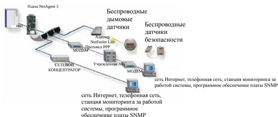
Стандартная топология сетевого управления ИБП
